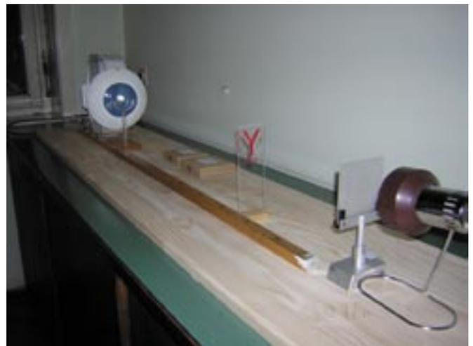
Kupljena oprema za Vježbe iz fizike: optička klupa i dodatna oprema za optičku klupu, te funkcionalni model oka.
