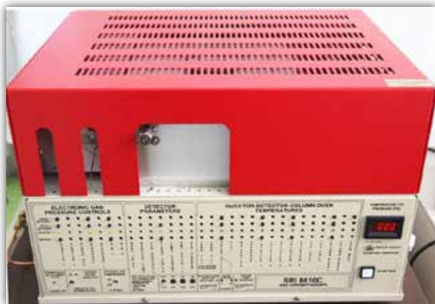
Slika 1. Plinski kromatograf SRI 8610 C opremljen plameno-ionizacijskim detektorom (FID)
