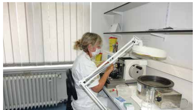
Izrada histoloških preparata - rezanje tkiva pomoću rotacijskog mikrotoma Leica RM 2135.
