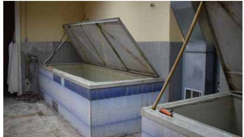
Prostor za pripremu anatomske preparata u prizemlju Zavoda prije obnove: spremnici za formalinizirane preparate.
