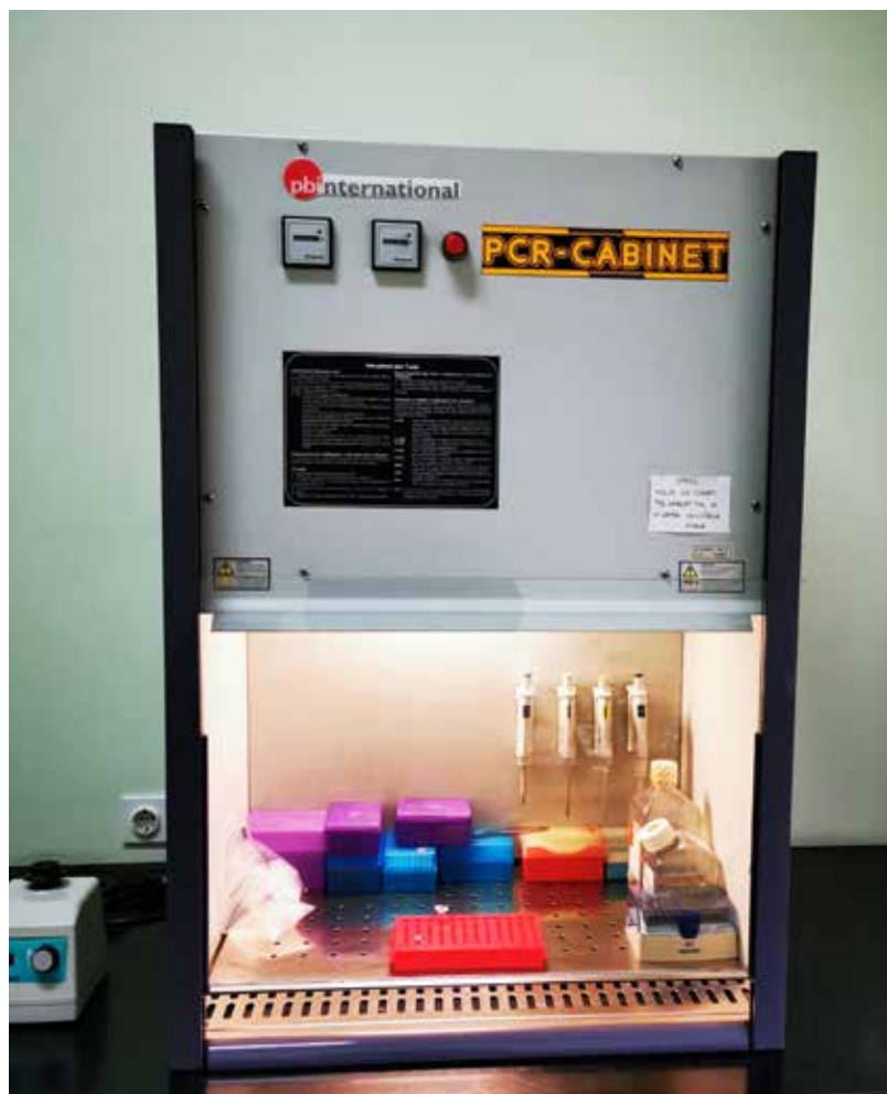
PCR kabinet s ultraljubičastom žaruljom i zračnom zavjesom za slaganje reakcijske smjese.
