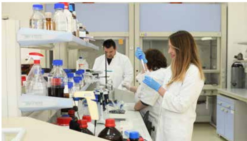
Slika 7. Djelatnici Zavoda provode analizu sirove masti u uzorcima silaže kukuruza u Laboratoriju za sigurnost i kvalitetu hrane za životinje. Analiza sirove masti dio je osnovne kemijske analize (Wendee metoda) koja se koristi za procjenu kvalitete hrane za životinje.
