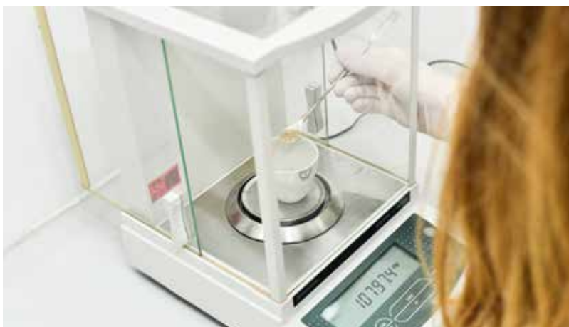
Slika 6. Docentica Diana Brozić važe uzorak krmiva na analitičkoj vagi. Vaganje uzoraka standardan je postupak u sklopu različitih metoda koje se izvode s ciljem određivanja nutritivnog sastava hrane za životinje.
