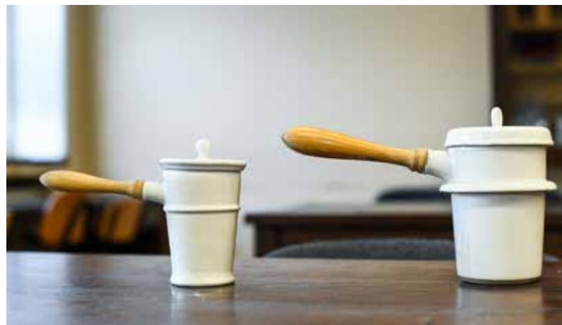
Porculanski lončić s poklopcem. Mogao se uranjati u vodenu kupelj, ne direktno zagrijavati.
