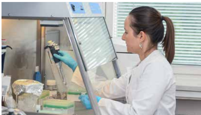
Priprema PCR master mixa u sterilnim uvjetima.
