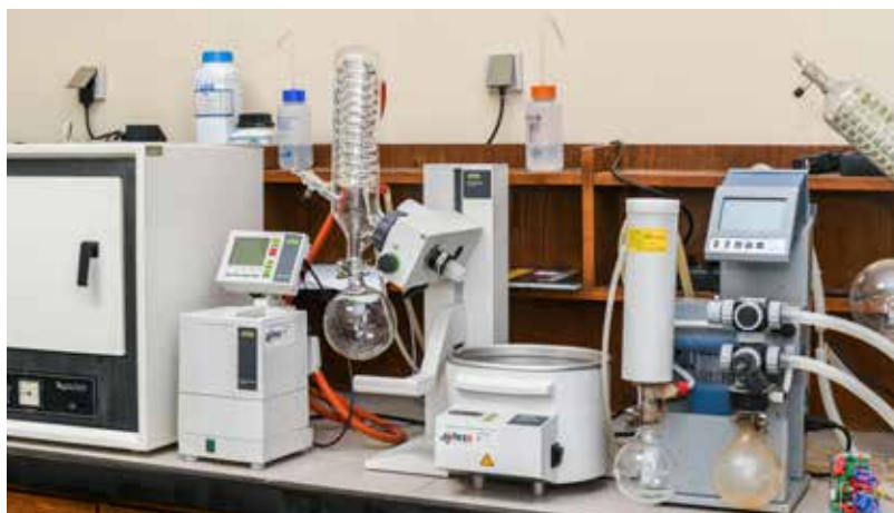
Rotacijski isparivač koji se koristi u izvođenju nastave iz kolegija Kemija prirodnih spojeva.
