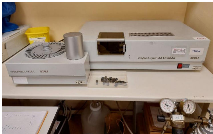
Slika 18. Uređaj za analiziranje uzoraka na prisutnost i kvantifikaciju žive AMA – 254.
