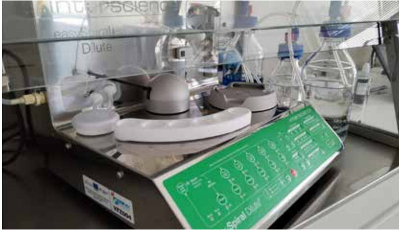
Robotizirani spiral dilutor u mikrobiologiji hrane, uređaj koji serijski razrjeđuje uzorak te ga naciepljuje na hranjive podloge eksponencijalno ili cirkularno.
