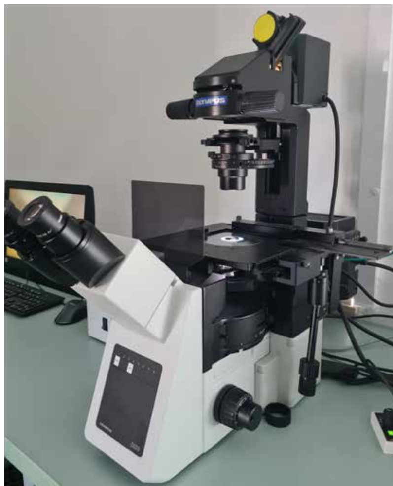
Invertni fluorescentni mikroskop za vizualizaciju fluorescentnih bojanja i očitavanje pretraga IF metodom.
