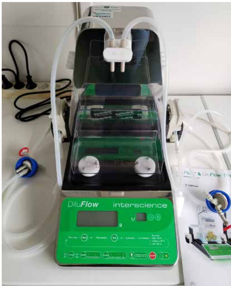
Gravimetrijski dilutor – automatizirani uređaj za pripremu osnovnog razrjeđenja uzoraka hrane
