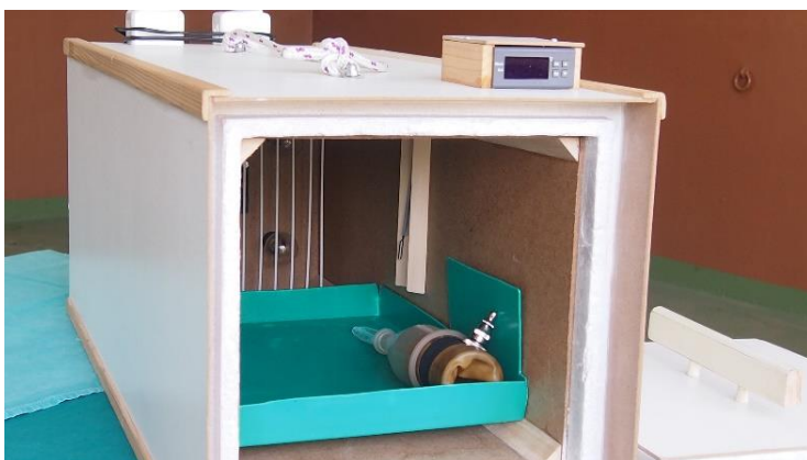
Slika 4.7. Kutija za prijenos umjetnih vagina s ugrađenim grijačem i termostatom (preuzeto od BERTA, 2019.)
