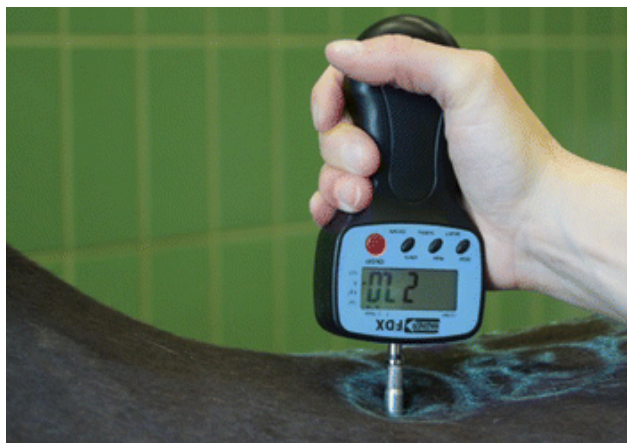
Slika 1. Ručni digitalni algometar koji se upotrebljava za mjerenje praga mehaničke nocicepcije na leđima konja (Pongratz i Licka, 2017.)
